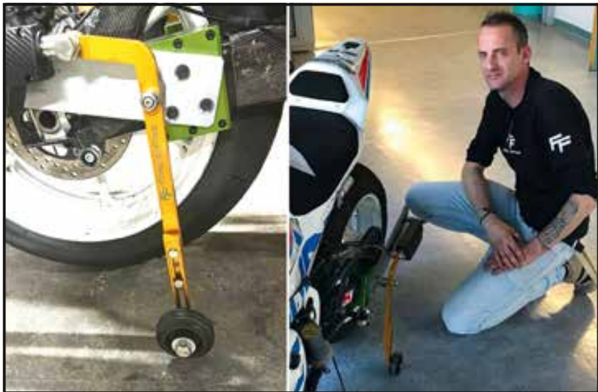
Le Vallonnien Maxime Pugin au côté de son système de bras oscillant rétractable, capable de stabiliser la moto lors des phases d'arrêt.
