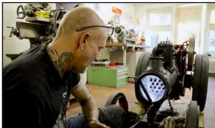
Sébastien Hirschy s'attaque aux 14 tubes qui composent la chaudière. Il faut éliminer les poussières et la suie qui devient acide et qui entraîne de la rouille en refroidissant.
