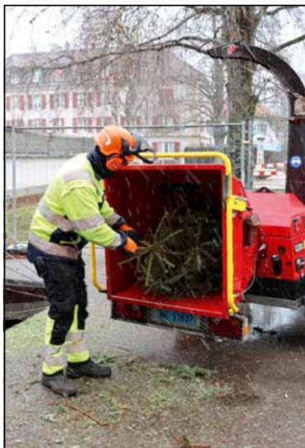
Le sapin entre entier dans la broyeuse et ressort « en miettes » dans la cuve qui alimente le chauffage à distance.
