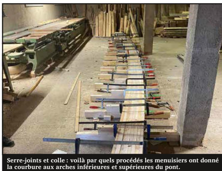
Serre-joints et colle : voilà par quels procédés les menuisiers ont donné la courbure aux arches inférieures et supérieures du pont.
